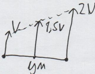
центр масс стержня находится в середине стержня и его скорость  $V_{ум} = \frac{V+2V}{2} = 1,5V$
