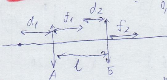
$\Gamma_1 = \Gamma_A \cdot \Gamma_B$ ; при передвигании линзы  $\Gamma_B$  меняется только  $\Gamma_B$
