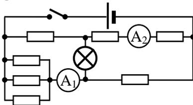
ключа лампочка загорелась. При этом первый амперметр ( $A_1$ ) показал, что через него течет ток  $I_1 = 1,8$  А. Какую величину силы тока показывал второй амперметр? Амперметры считать идеальными.
