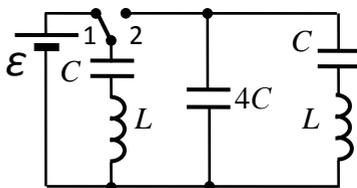
переводит ключ в положение 2 в момент, когда заряд «левого» конденсатора достиг максимального значения. Найти закон изменения заряда на «правом» конденсаторе после этого момента времени. До начала использования все конденсаторы были разряжены. Сопротивления всех элементов схемы на рассматриваемых интервалах времени можно пренебречь, остальные их параметры показаны на рисунке.
