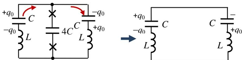
ток всегда равен нулю, и его можно убрать из схемы. Последовательно соединенные конденсаторы  $C$  оказываются в данном контуре эквивалентны одному конденсатору емкостью  $\frac{C}{2}$ ,
