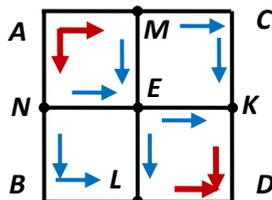
(две перемычки, ближние к  $A$  -  $ME$  и  $NE$ ) или растекаются (две перемычки, ближние к  $D$  -  $EL$  и  $EK$ ) одинаковые токи, силу которых обозначим  $I'$ . Тогда через точку  $C$  течет ток  $\frac{I}{2} - I'$ .
