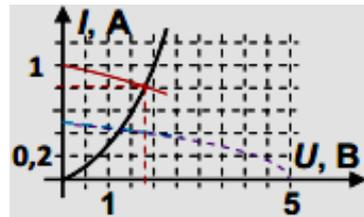
напряжения на нем задается некоторой функцией, график которой – это вольтамперная характеристика. Обозначим ее  $I_D = f(U)$ . Тогда напряжение на лампе
