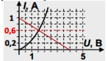
**Решение задачи:** Пусть  $U$  – напряжение на диоде. Положительные направления токов в схеме выберем так, как показано на рисунке слева. Зависимость силы тока через диод от
