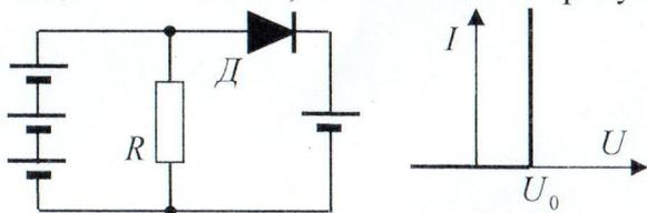
Пороговое напряжение диода  $U_0$  считать известным.
